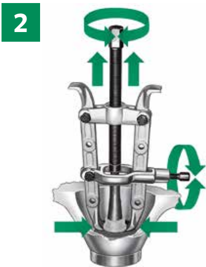
Functionerings-principe van een twee-armige trekker
