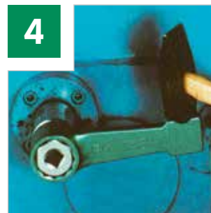
4 STAHLWILLE ringslagsleutels nr. 8 met twaalfkant zijn sterker, dunner en hoger
